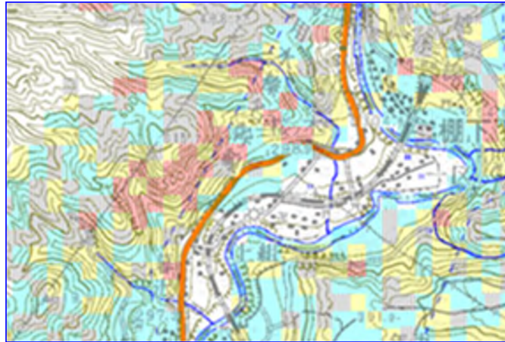
図 3. 2. 4. 山腹崩壊危険度による危険斜面の抽出事例
