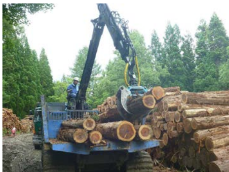
【フォワーダによる運材作業】
