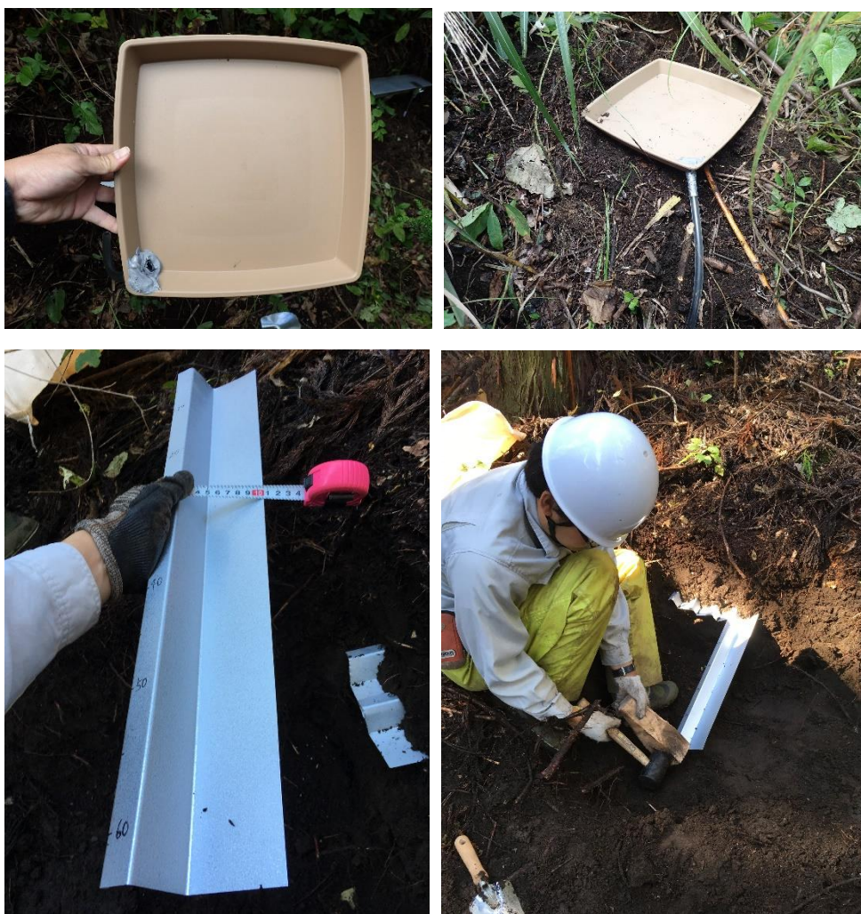
写真 6-1 ゼロテンションライシメータ設置状況写真 (1) (飯館事業地 (1))
