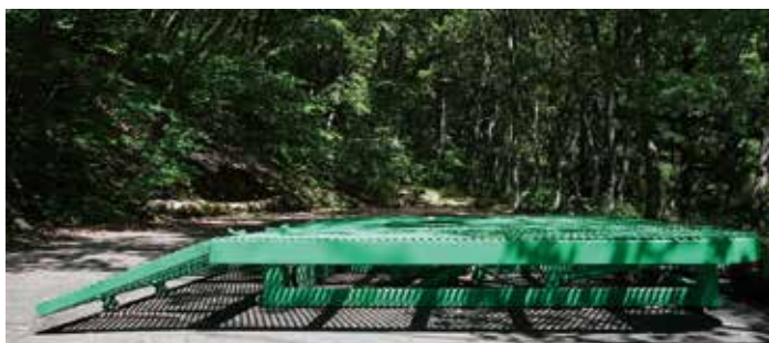
0 度から最大 25 度まで 5 度ずつ 6 段階に傾斜角を変えられます。
