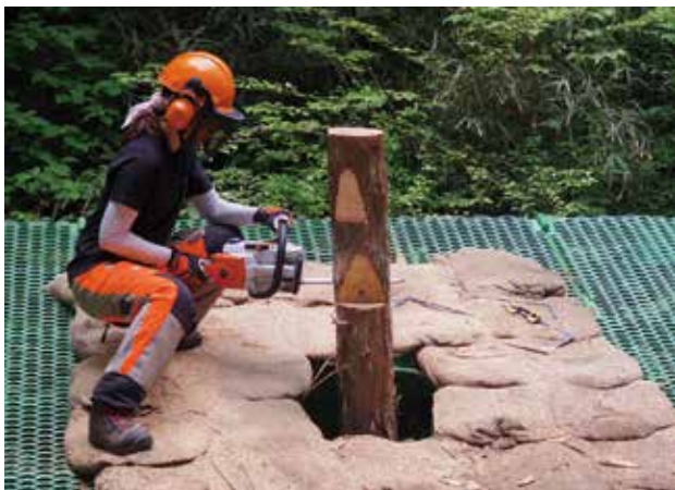
Step10：幅と高さが均等なツルを作るために追い口を切る。
