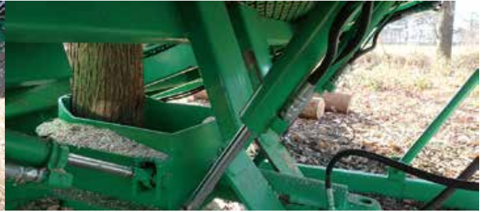
4 本の油圧シリンダーで丸太を全方向に傾けられます。
