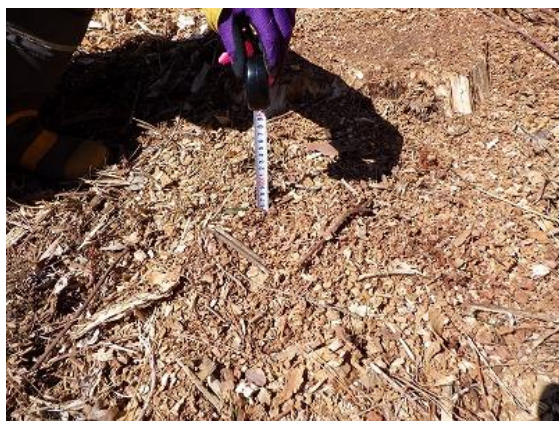
(a) 多目的造林作業機による地拵え（伐根の破碎処理）後の地表面の状況
