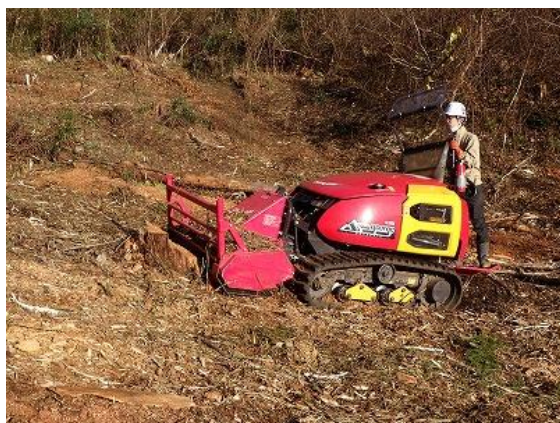
写真 4-1 「造林機械地拵え区」における多目的造林作業機での地拵え実施状況
