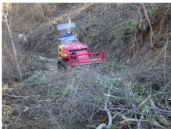
写真 4-3 「造林機械+人力地拵え区」における枝条の集積・破碎作業の実施状況
