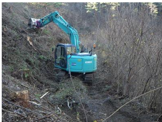
写真 4-3 「造林機械+人力地拵え区」における枝条の集積・破碎作業の実施状況
