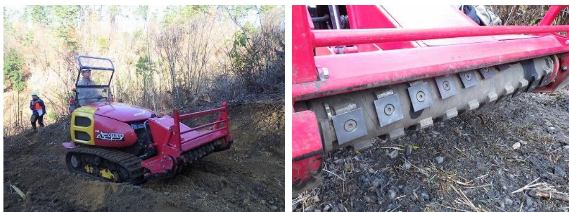
写真 2-8 多目的造林作業機「山もつとモット」(左) 及び「オーロラランプシェーバー」(右)
