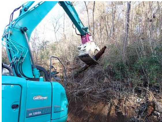
グラップルで残材を除去して確保した侵入口から、「山もっとモット」が林地内へ侵入
