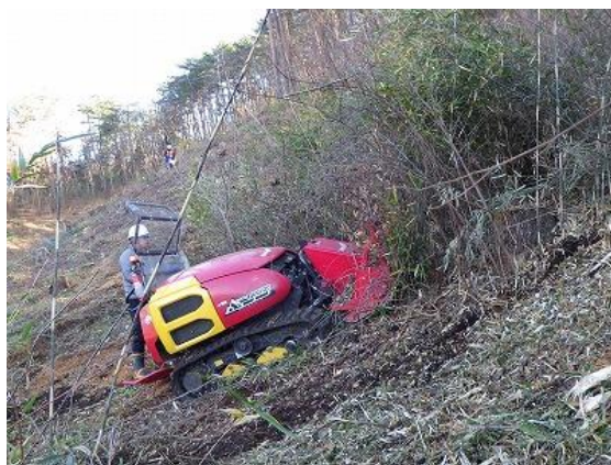
写真 4-1 「造林機械地拵え区」における多目的造林作業機での地拵え実施状況
