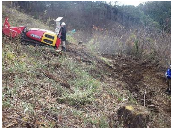
作業道上側の段になっている箇所をグラップルで均し、多目的造林作業機が斜面に侵入。
