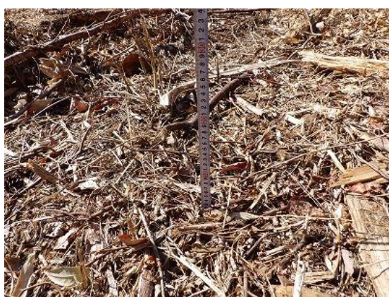
(b) 多目的造林作業機による地拵え（灌木の破碎処理）後の地表面の状況
