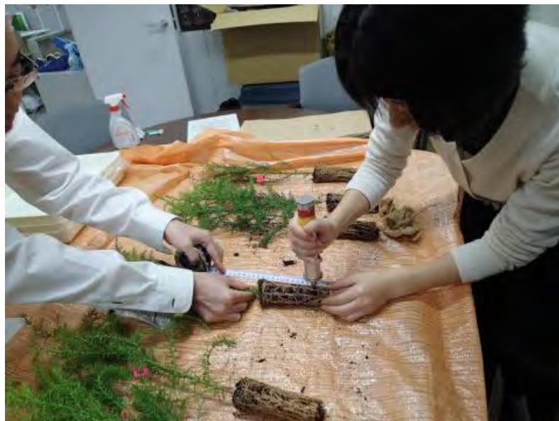
写真 3-1 根鉢の硬度計測の様子
