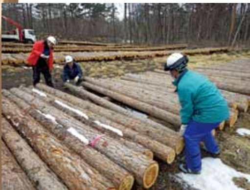
写真3 曲がりや節の状況、皮むけや目まわり等の欠点を細かく確認しながら、丸太を選木する様子
