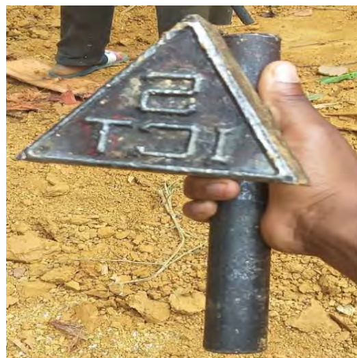
図 3.17 伐採業者固有の刻印ハンマー
