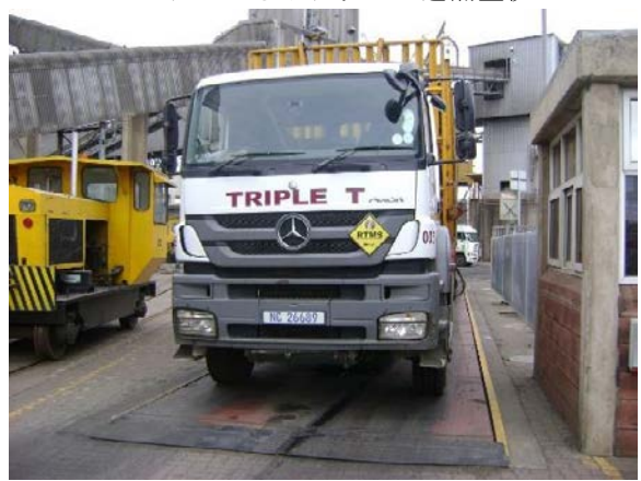
トラック積荷重量の点検
