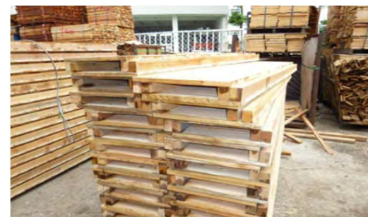
台湾で使用されているコンクリート型枠板と使用現場 日本木材輸出振興協会：台湾における木材需給と木材産業の現状と動向より
