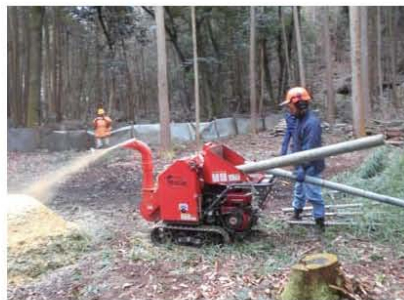
チップパーでのチップ化作業
