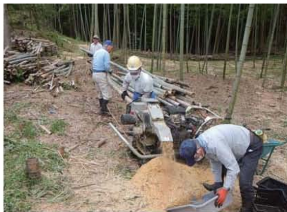
チップパーによる竹のチップ化
