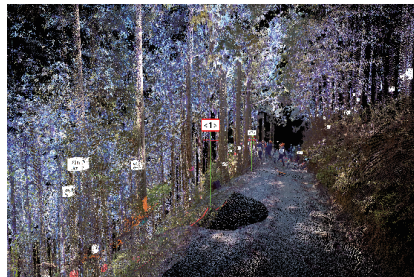
地上レーザ測量データの解析画像
