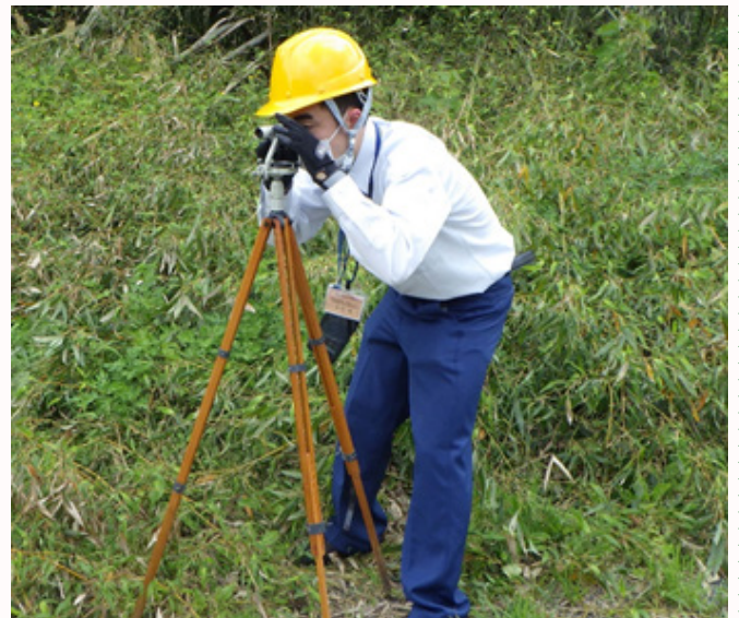
コンパス測量の様子
