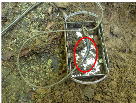
図3-1 使用したくくりわなと合成樹脂で覆ったワイヤーのくくり部分（赤丸）
