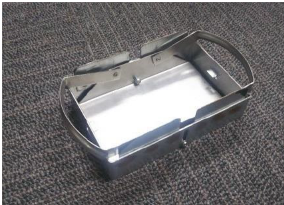
図 3-5 使用したくくりわなと合成樹脂で覆ったワイヤーのくくり部分
