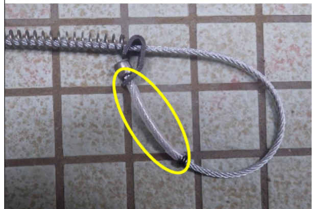
図 3-5 使用したくくりわなと合成樹脂で覆ったワイヤーのくくり部分
