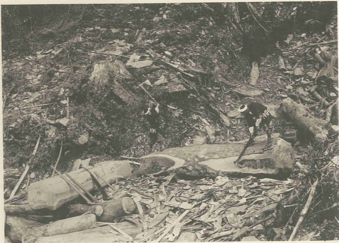
高知縣長岡郡吉野村大字七戸、龍王山國有林、29林班の斫伐箇所にて於ける樺の 杣角を造材する狀況なり 角は締め方をなるべく緩くし、尙ほ木の形態に應じて邊材の小部分を適度に 除くものとす
