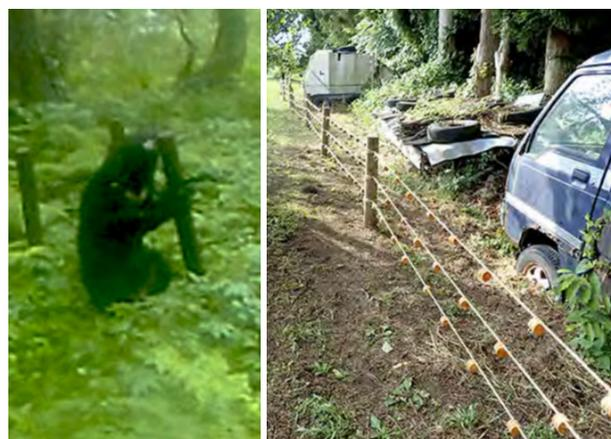
防蝕処理した木材へのかじりつき（左）とクマ侵入防止柵の現地試験の様子（右）
